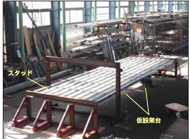
写真 1 試験体全景 (片側面材施工前)
