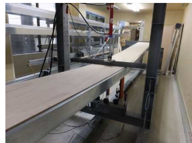
写真4 中央集中荷重加力試験 試験体No.4 終局時全景
