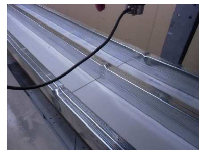
写真6 中央集中荷重加力試験 試験体No.4 終局部近景
