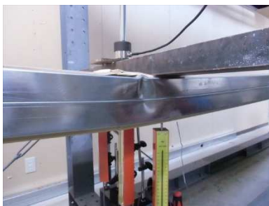
写真5 中央集中荷重加力試験 試験体No.4 終局時近景
