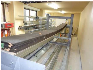
写真3 等分布荷重載荷試験 試験体No.1 2500N/m 2 載荷時
