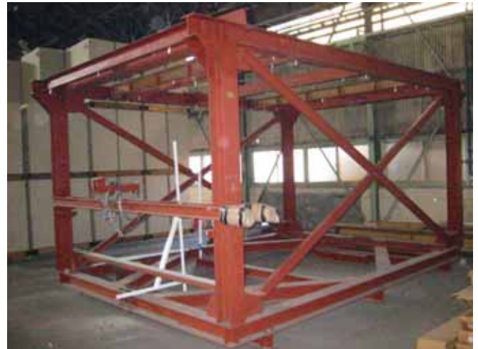
写真1 加力フレーム
