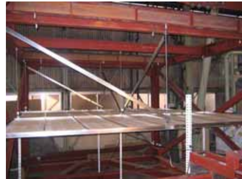
写真1 クロスタイプ試験体設置例
