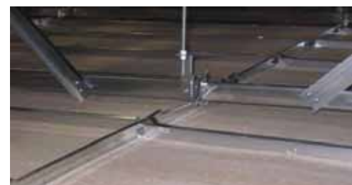
写真7 試験 No.9 チャンネル T バー接続金具の変形
