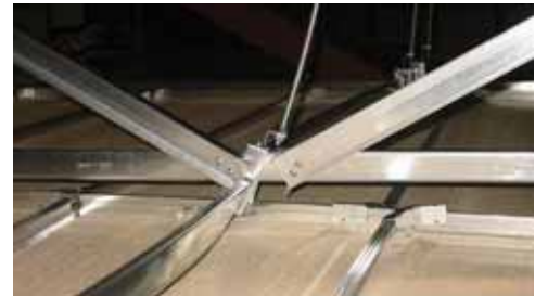
写真5 試験 No.8 試験後ブレース取付部の変形
