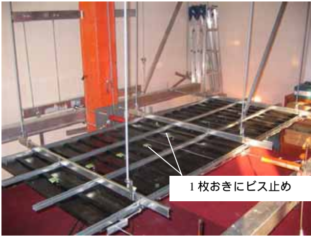
写真2 試験体 AC4 ビス補強状況
