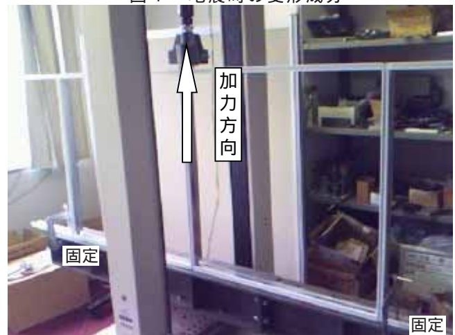
写真1 Tバーのみの加力実験状況
