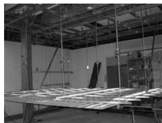
写真1 試験体全景 (従来型防振天井)
