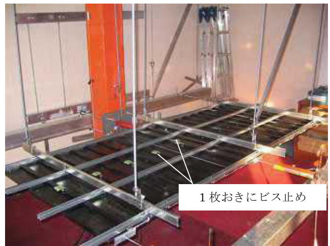
写真3 試験体AC4ビス補強状況
