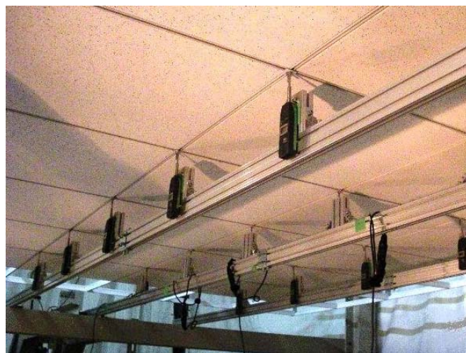
写真2 試験体（変位測定状況）
