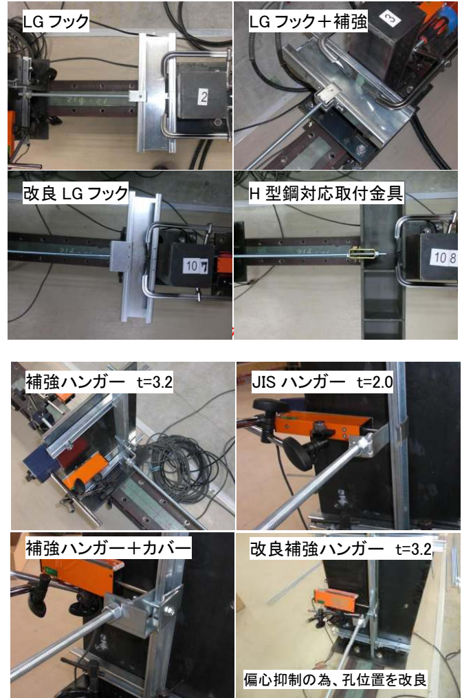
写真2 吊りボルト下端
