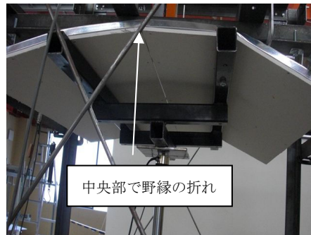
写真3 試験体 V-4 破壊状況
