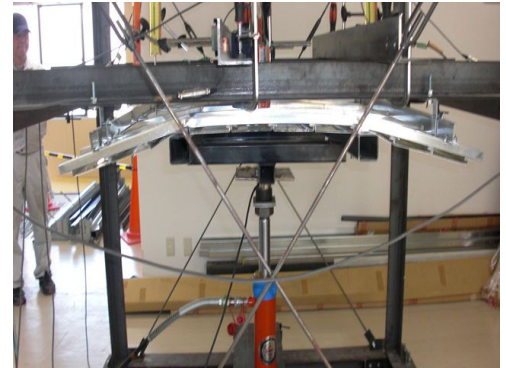
写真1 試験体1 破壊状況
