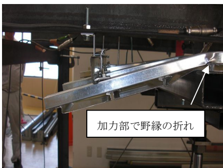
写真2 試験体 V-2 破壊状況
