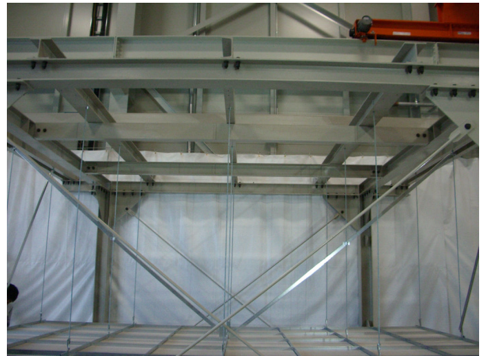
写真3 試験体の例 (No.4 V字1段ブレース配置)
