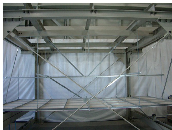
写真2 試験体の例（No.2 V字2段ブレース配置）
