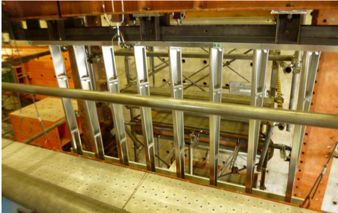
写真1 スタッド上部の振り変形
