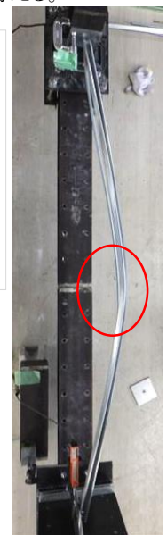
写真5 補強材の座屈
