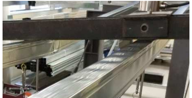
写真1 連続波状座屈現象
