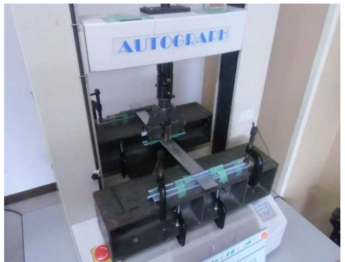
写真4 フランジ試験体加力状況
