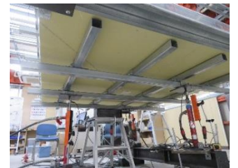
写真1 加力治具設置
