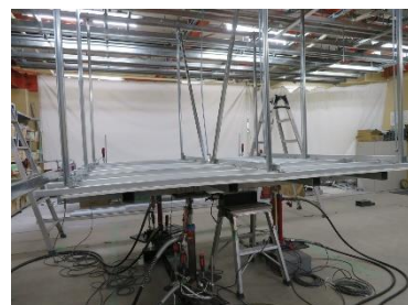
f)Case3-2 吊りボルトの座屈
