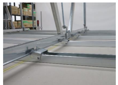
g)Case3-2 野縁受け強軸曲げ変形
