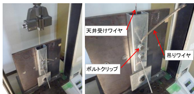
図6 試験体設置状況
