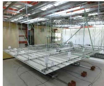
図2 試験体全景(クリップ除去前)
