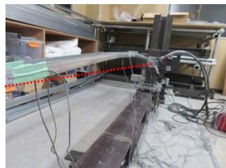
写真6 プレース材の弱軸方向曲げ変形
