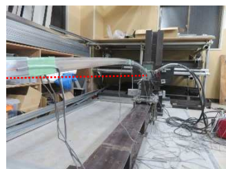
写真8 プレース材の弱軸方向曲げ変形
