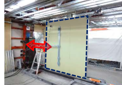
写真1 慣性力試験_試験体
