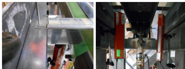
写真3 巻込型変位計取付状況
