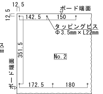
図3b 試験体 No.2 面材ビス位置詳細
