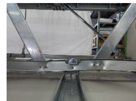
写真3 野縁受けの局部座屈
